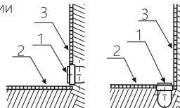
А – вывод канализации устраивается в уровень с полом из стены, или из пола под срез кафельной плитки. Допускается уровень канализационной трубы не выше 7 см над уровнем пола в верхней точке. Если высота канализации не позволяет вывести на данную высоту вывод, то изготавливается подиум, повторяющий форму поддона с допуском по периметру не менее 5 см. Высота подиума зависит от высоты вывода канализации. Подиум, также, как и пол под ванной, должен быть выложен плиткой.
