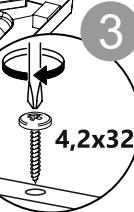
**⚠** Просверлить отверстия Ø2,5
